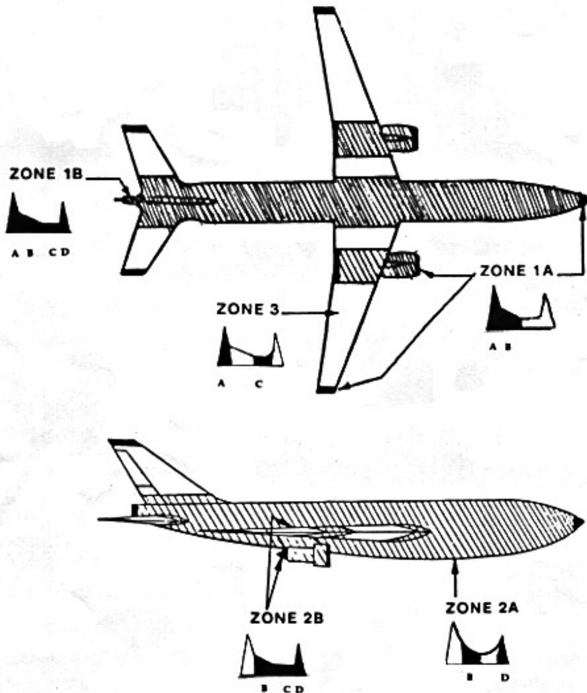
**FIGURE 2 LIGHTNING STRIKE ZONES (TYPICAL)**
