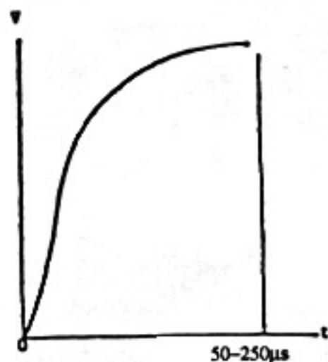
**FIGURE 6 VOLTAGE WAVEFORM 'D'**
