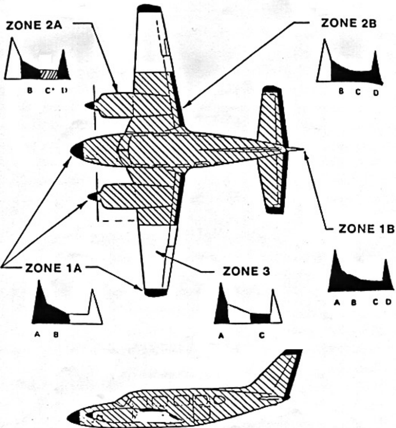
**FIGURE 3 LIGHTNING STRIKE ZONES (TYPICAL)**
