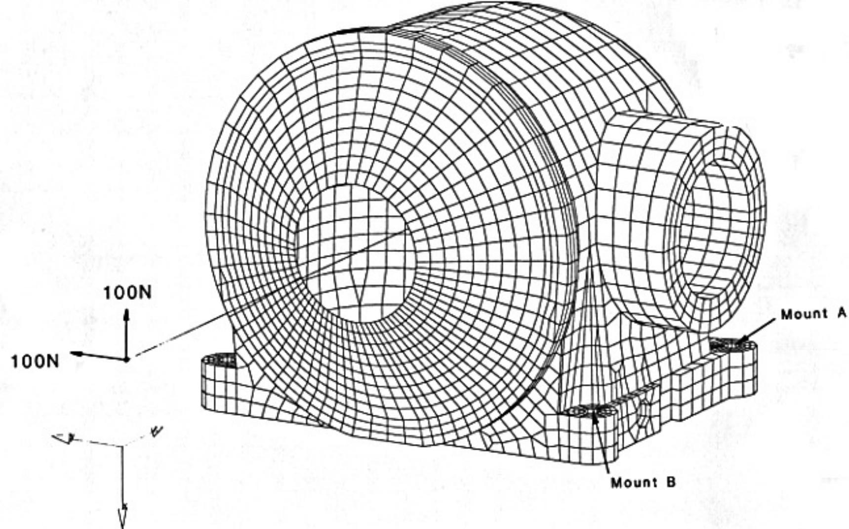
FINITE ELEMENT MODEL SHOWING LOADING LOCATIONS
